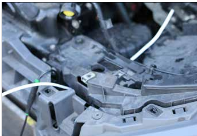
Tirez le câble de la caméra à l'aide du tire-câble dans le compartiment moteur.
