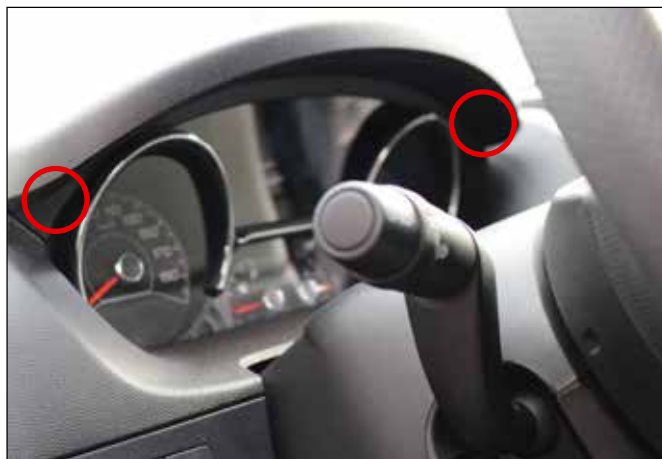
Il y a deux vis sur les côtés gauche et droit sous le couvercle
