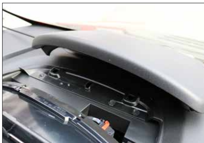
La pièce est maintenue à l'arrière par trois ergots en plastique. Faites levier avec un tournevis et retirez la couverture.
