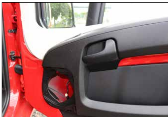
Retirer les haut-parleurs à gauche et à droite.
