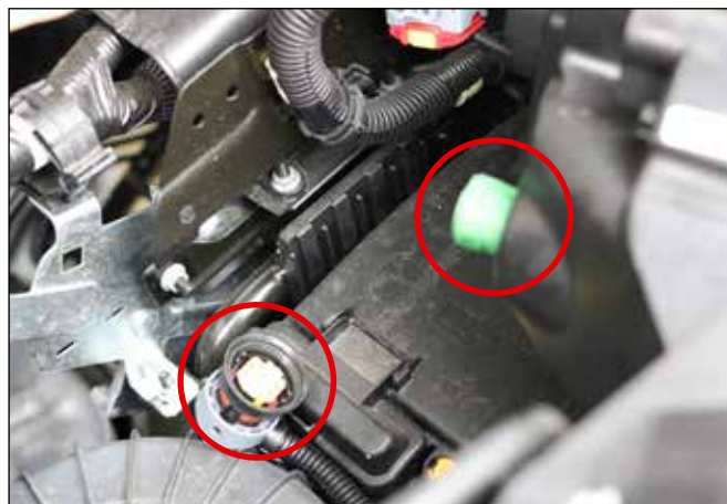
Le câble du phare est détaché.
