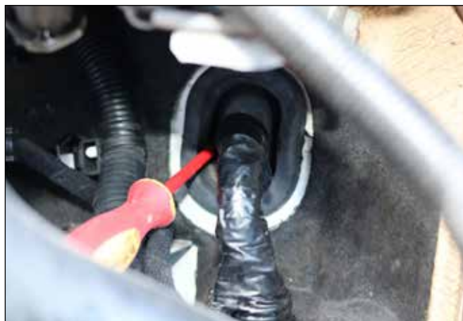
Percez une fente dans l'ouverture à l'aide d'un tournevis pour laisser passer le câble.
