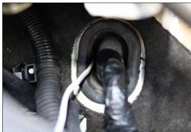
Faites passer le câble à l'aide du tire-câble.
