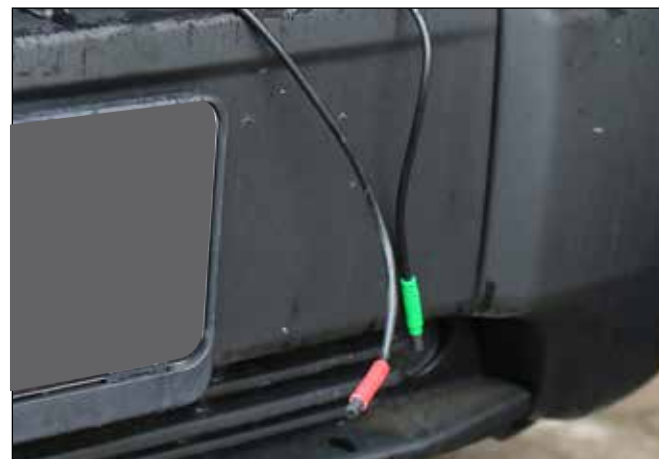
Laissez 10 cm de câble. Ensuite, posez le câble d'extension de la caméra frontale (n° 8). Raccordez les câbles entre eux et fixez-les.
