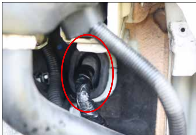
Le câble doit passer par cette ouverture.
