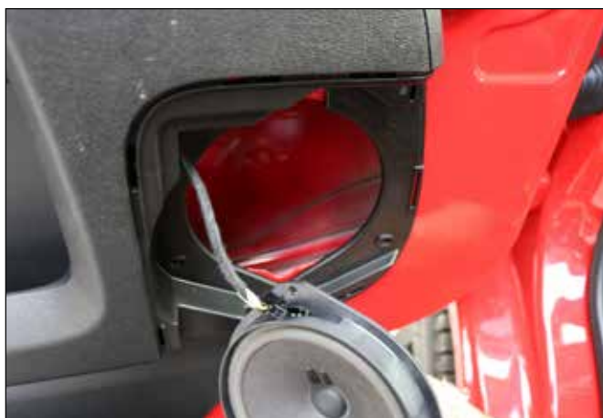
Retirer les haut-parleurs à gauche et à droite.
