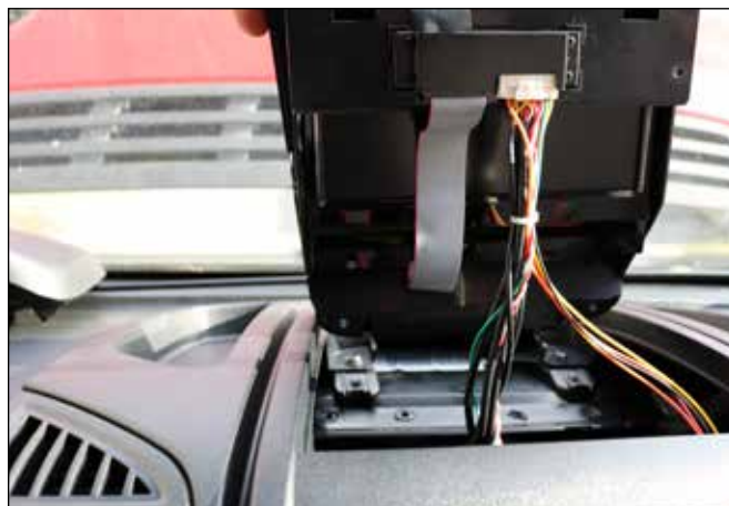
Fixer l'écran. Utilisez les écrous en tôle de la couverture originale à l'avant.
