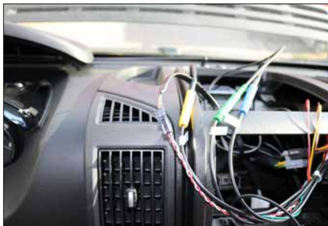
Connecter le câble au harnais de câblage du moniteur (n° 16). Voir schéma de raccordement en fin de notice.
