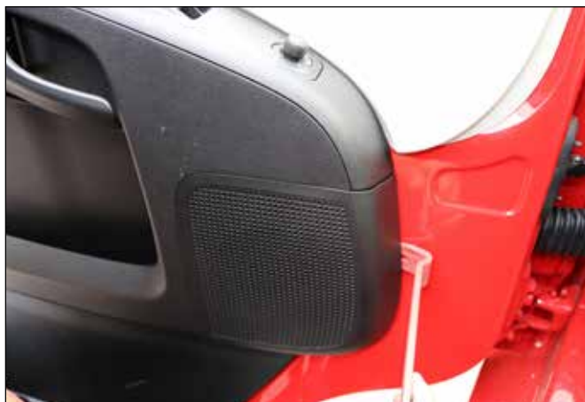
Enlever le couvercle à l'aide du levier de démontage. Remarque : Attaches sur le coude inférieur. Veuillez les replier pour éviter un vide.
