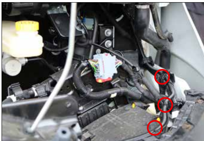
Fixer le câble avec des colliers de serrage
