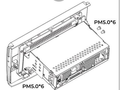
Die Bildschirmhalterung verfügt über mehrere Optionen, die es dem Monteur ermöglichen, die Höhenposition der Halterung zu bestimmen. Bitte wählen Sie die Einbauposition, die am besten für die Installation geeignet ist.
