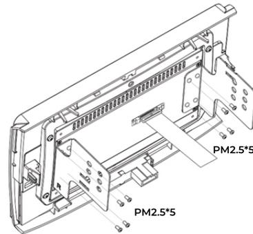
Befestigen Sie die Metallbügel mit Schrauben an das Display
