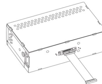
Schließen Sie das Verbindungskabel direkt an die Headunit an
