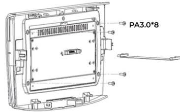
Befestigen Sie die blende mit Schrauben an der Schalttafel und Verbinden Sie das Anschlusskabel direkt mit dem Panel
