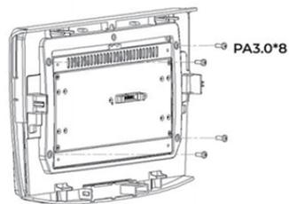
Befestigen Sie die blende mit Schrauben an das Display
