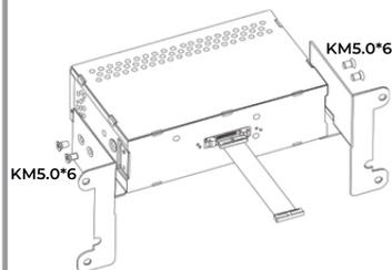
Befestigen Sie die Metallbügel mit Schrauben an das Radio
