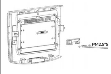
Befestigen Sie die Kunststoffhalterung mit Schrauben an das Display
