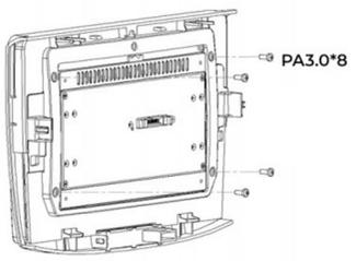
Befestigen Sie die blende mit Schrauben an das Display
