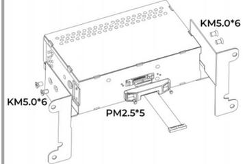
Befestigen Sie die Kunststoffhalterung und Metallbügel mit Schrauben an das Radio
