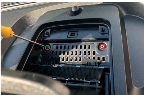
Öffnen Sie das Ablagefach und lösen die 2 Schrauben.
