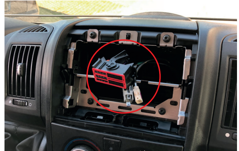
Nur bei Radio ab Werk: Entfernen Sie die Stecker auf der Rückseite des Radios.
