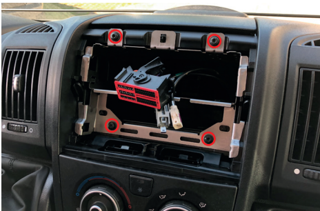
Nur bei Radio ab Werk: Lösen Sie die 4 Schrauben.
