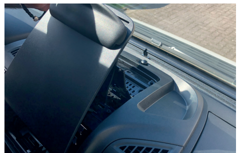
Ziehen Sie das Ablagefach nach oben heraus.
