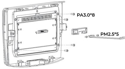
Befestigen Sie die Kunststoffhalterung und blende mit Schrauben an das Display
