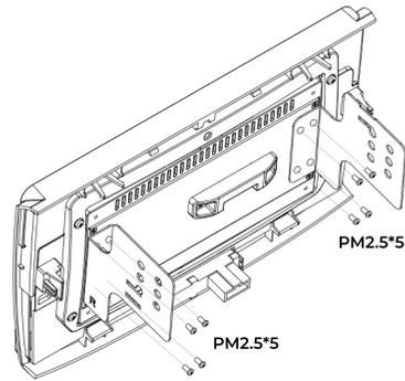
Befestigen Sie die Metallbügel mit Schrauben an das Display
