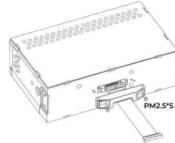
Befestigen Sie die Kunststoffhalterung mit Schrauben an das Radio
