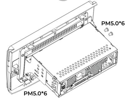
Die Bildschirmhalterung verfügt über mehrere Optionen, die es dem Monteur ermöglichen, die Höhenposition der Halterung zu bestimmen. Bitte wählen Sie die Einbauposition, die am besten für die Installation geeignet ist.
