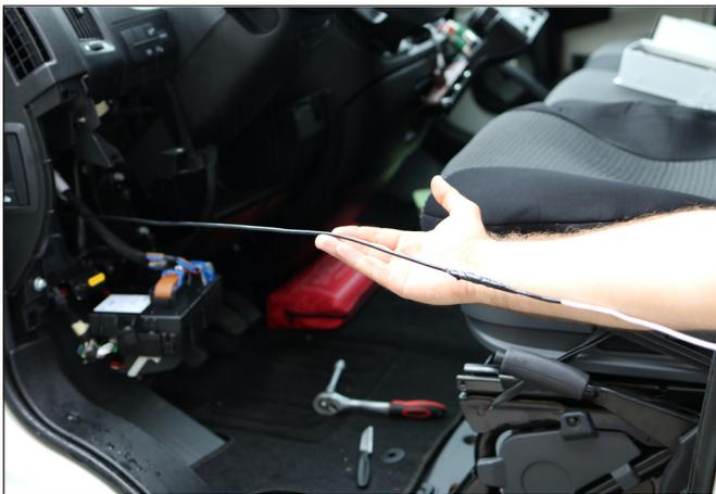
Das Kabel ist durch. Jetzt nach oben und seitlich zur Mittelkonsole / Monitor führen.
