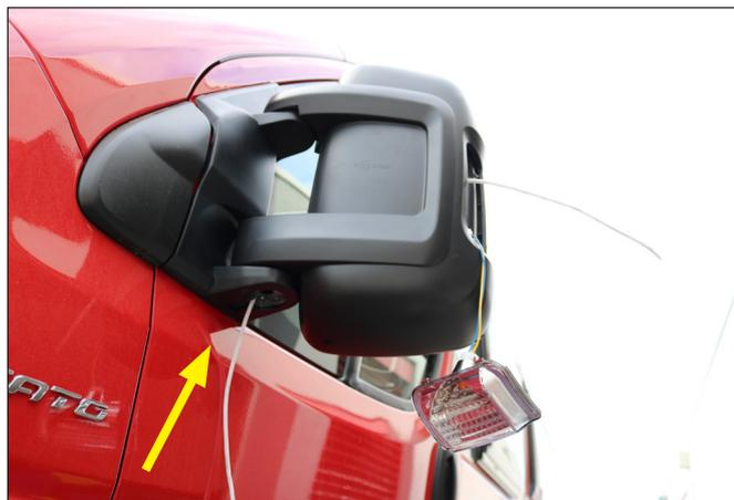
Ziehen Sie die Kabeldurchziehhilfe (Nr. 4) wie abgebildet von unten nach oben durch den Seitenspiegel.
