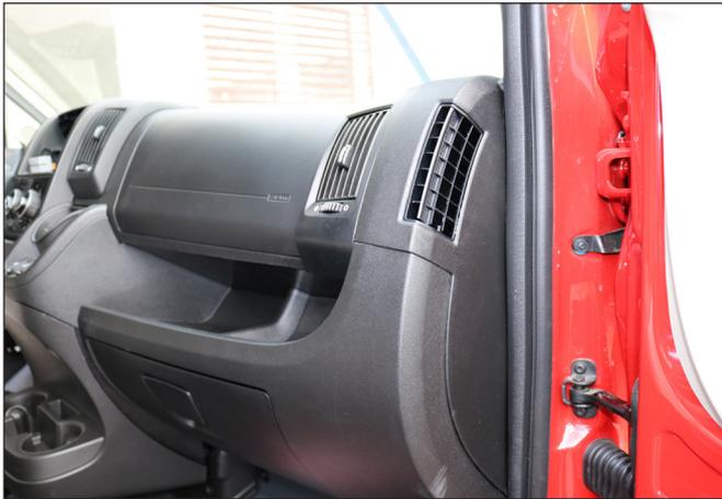
Das Handschuhfach oben und unten muss entfernt werden, um die Kamera-Kabel verlegen zu können.
