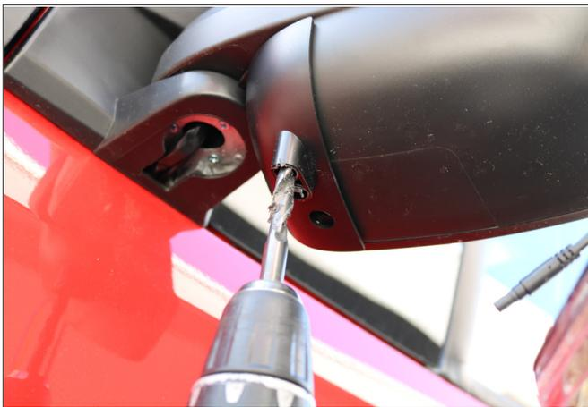
Bohren Sie zwei Montagelöcher.
