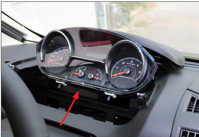
Ziehen Sie das Kombiinstrument nach oben.
