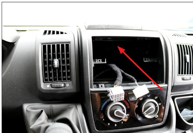
Unterhalb der Ablage müssen zwei Schrauben entfernt werden.
