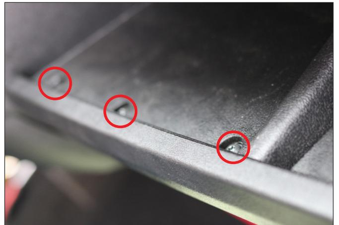
Das untere Fach wird mit fünf Schrauben befestigt. Entfernen Sie die drei ersten Schrauben, die das untere Handschuhfach befestigen.
