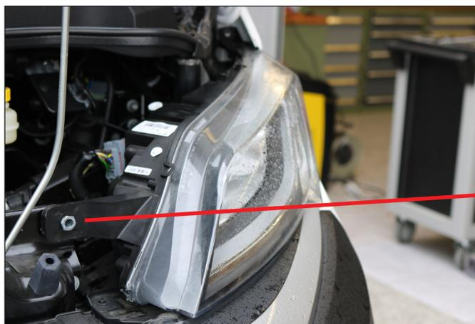
Zunächst muss die Scheinwerfer-Einheit ausgebaut werden.
