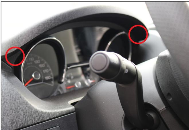
Links und rechts unter der Verkleidung befinden sich zwei Schrauben
