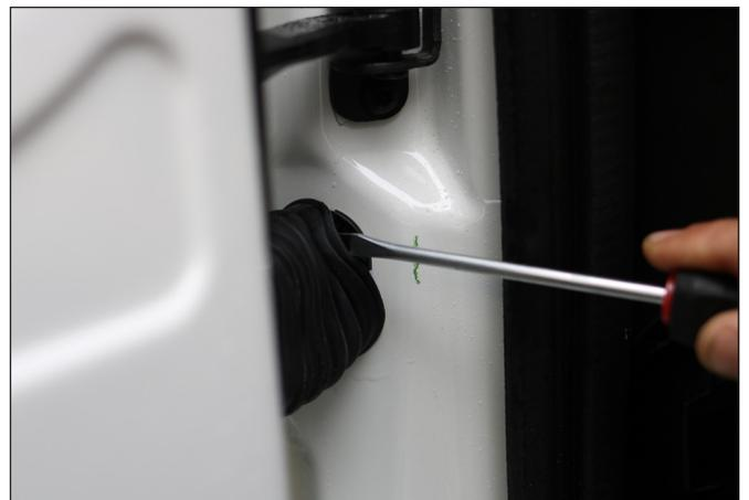
Lösen Sie den Faltenbalg auf der Fahrzeugseite und
