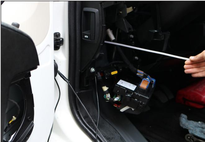
Lösen Sie den Stöpsel auf der Fahrzeugseite, und ziehen Sie das Kabel durch.
