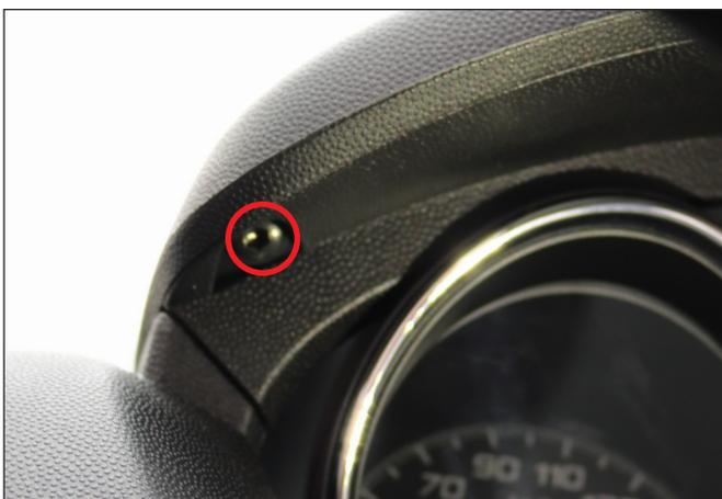
Entfernen Sie die linke Schraube.
