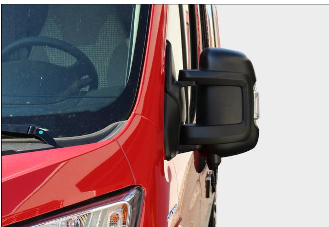
Die Seitenkamera ist montiert.
