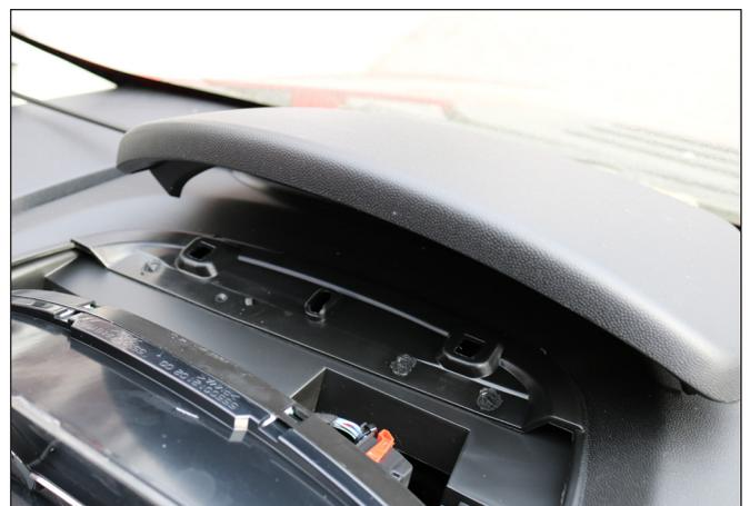
Die Verkleidung wird hinten durch drei Plastiknasen gehalten. Mit Schraubenzieher heraushebeln und Verkleidung entfernen.
