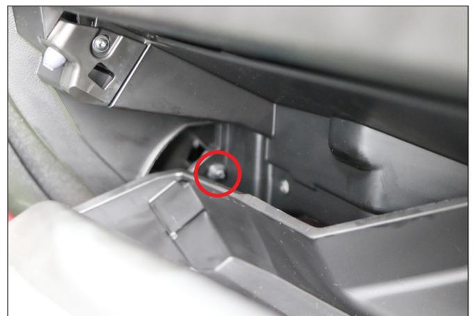
Entfernen Sie noch die fünfte Schraube und entfernen Sie das Handschuhfach.
