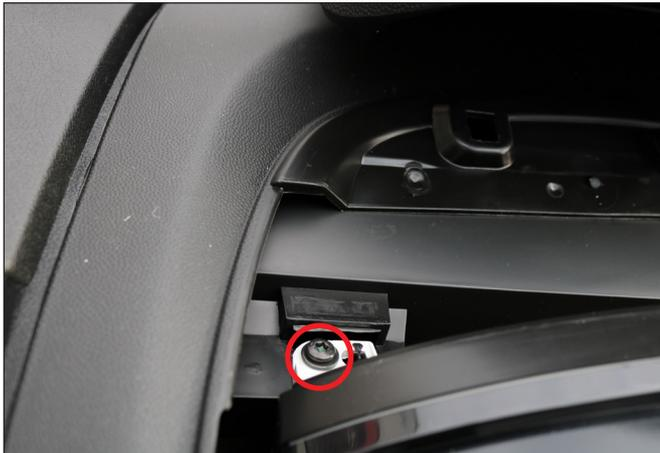
Entfernen Sie die linke Schraube.
