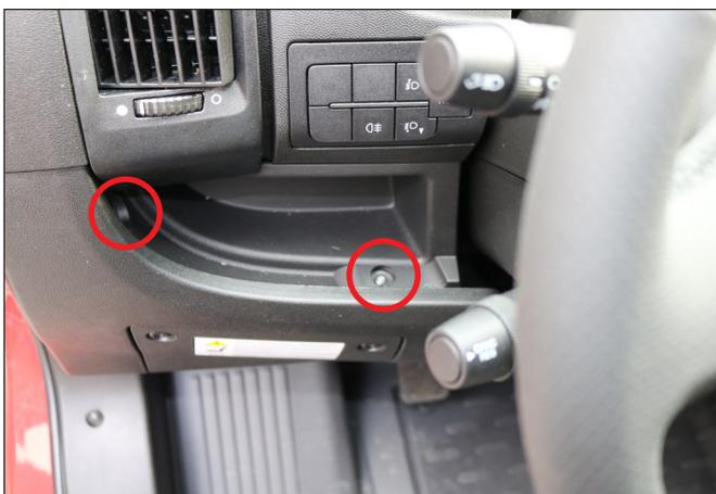
Entfernen Sie die Schrauben.
