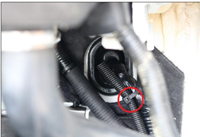
Das Kabel mit Kabelbindern befestigen
