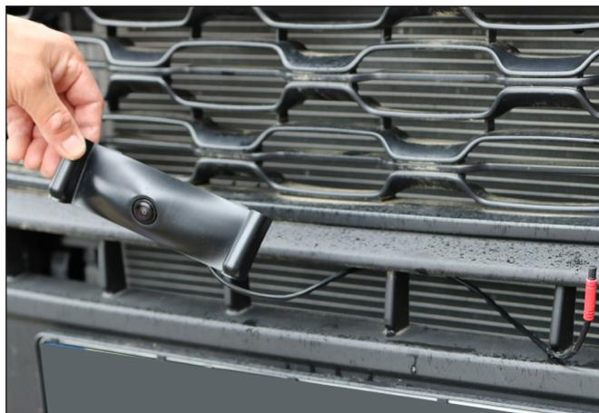
Kamerakabel nach hinten führen und Kamera anbringen. Die Kamera wird einfach eingerastet.
