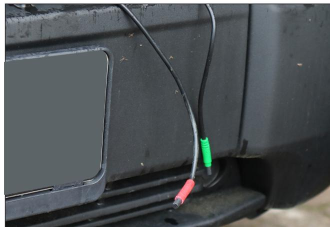
10 cm Kabel übrig lassen. Als nächstes das Front-Kamera-Verlängerungskabel verlegen (Nr. 8). Kabel zusammenführen und befestigen.
