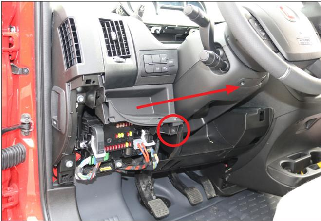
Der Sicherungskasten liegt frei. Schraube lösen und Fach entfernen.
