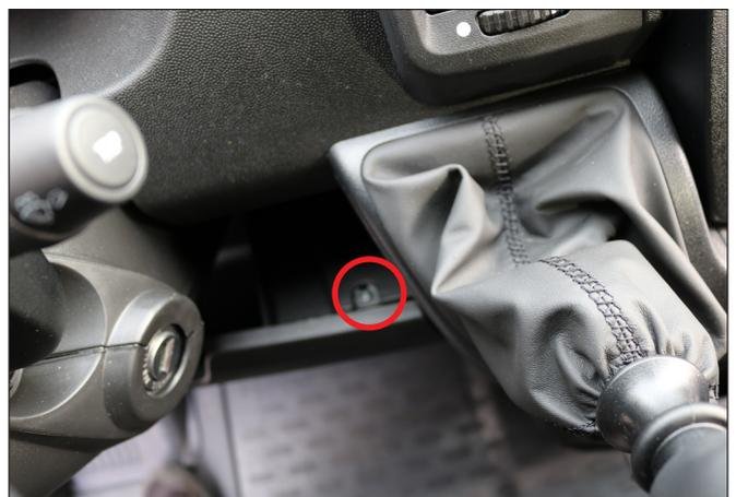
Entfernen Sie die Schraube.
