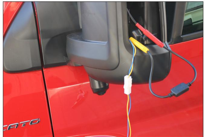
Stecker verbinden und hinter dem Spiegel platzieren. Leuchte wieder einsetzen und festschrauben.
