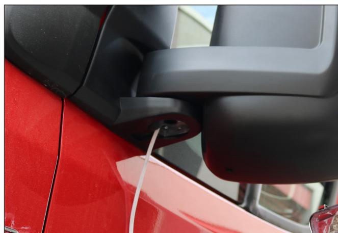
Befestigen Sie das Kabelende an die Durchziehhilfe und schieben Sie diese durch die Öffnung wie abgebildet.
