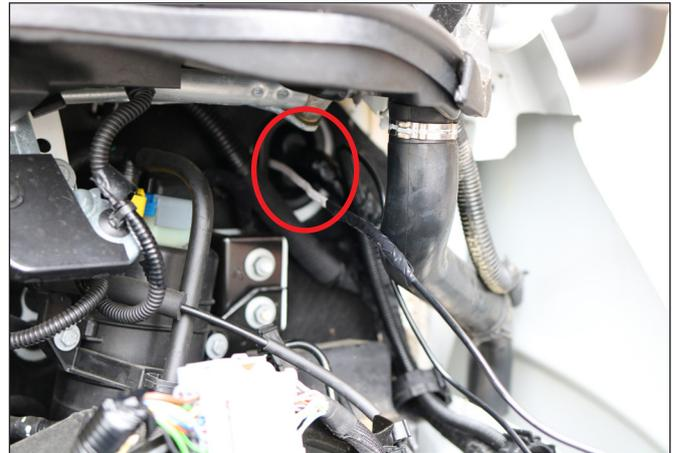
Kabel in einem Kabelkanal (Wellrohr) führen. Dann an Durchziehhilfe binden und in den Innenraum ziehen. Stechen Sie einen Schlitz in die Öffnung durch, um das Kabel durchzulassen.
