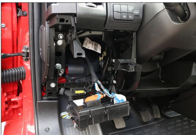
Klappen Sie den Sicherungskasten herunter.
